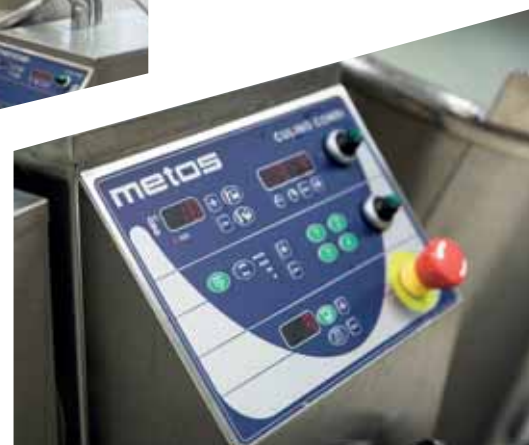
Le panneau de commande permet de visualiser et de modifier la température et la durée de cuisson, la vitesse de brassage et le basculement
