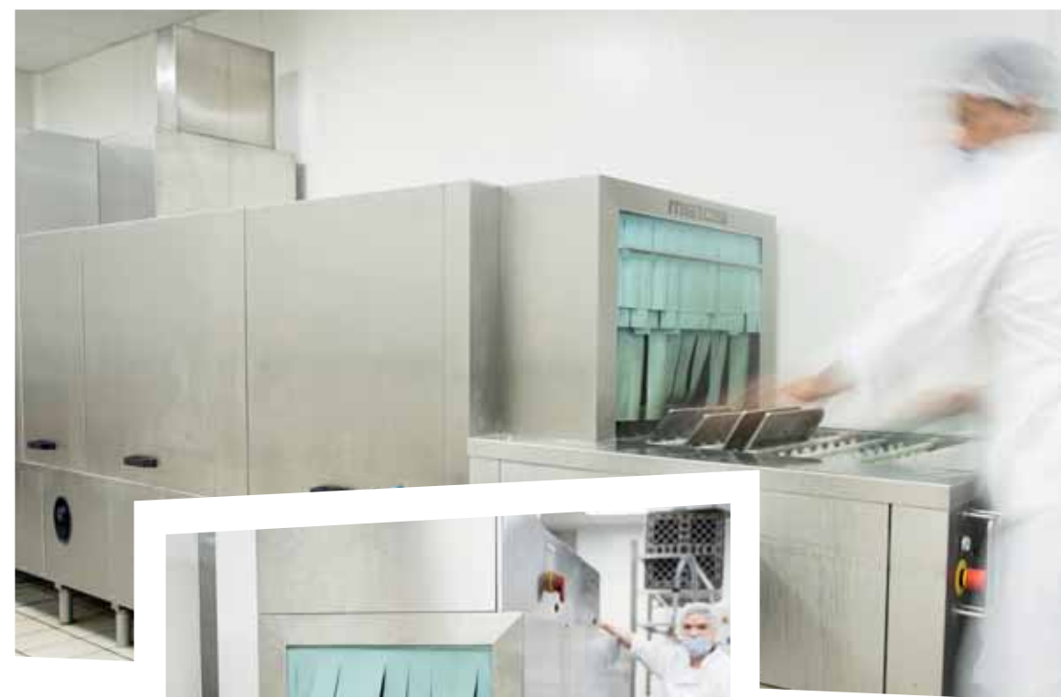
Le lave-batterie à convoyeur à doigts négatifs permet de laver, à la fois, les plateaux, les cagettes ou la vaisselle directement posée sur le tapis
