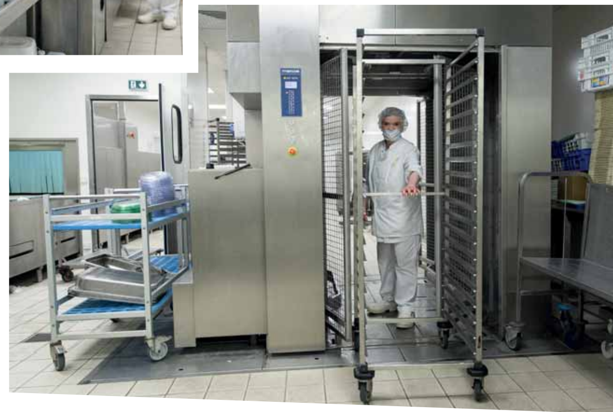
Le choix d'un lave-batterie à granules traversant allie facilité d'utilisation et efficacité
