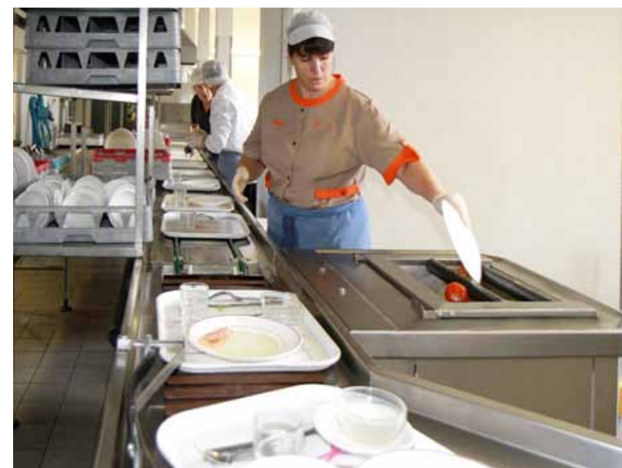
Les plateaux sont acheminés dans la zone de lavage via un tapis bi-cordes. Une fois débarrassés, ils sont directement transférés dans un lave-plateaux
